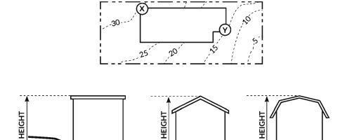
FIGURE 18.02.030.C: MEASURING BUILDING HEIGHT
